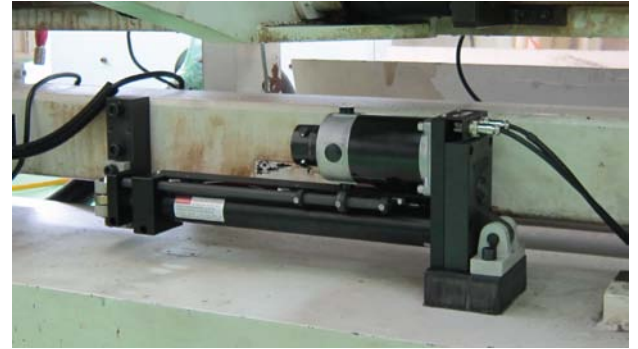
Elektrik Aktüatör SA dilimleme makinesi sargı açma işlemi için kullanılmaktadır.
